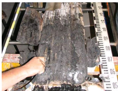
Slika 27: Navpična trasa po sežigu
