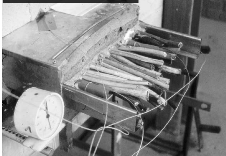
Prüfaufbau der ersten OBO-Kabelabschottung
