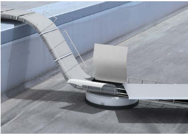
Über Brandwand geführte bandagierte Leitungen
